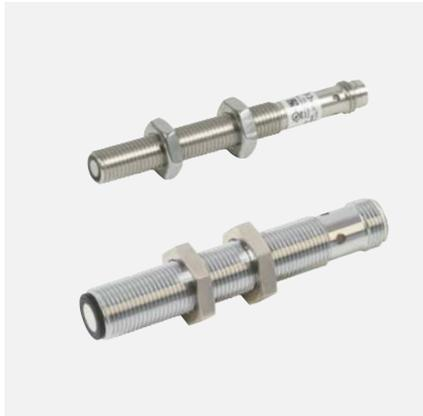
Die kleinsten Ultraschallsensoren im M8 Gewindegehäuse gibt es in vier Varianten, und zwar als Taster oder Schranke, jeweils mit den Schnittstellen PNP oder NPN. Dabei besitzen die Sensoren eine Reichweite von 100 Millimetern und eine Blindzone von gerade einmal 20 Millimetern.
