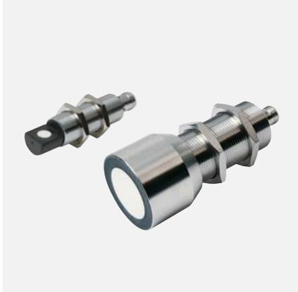
Dieser Sensor bietet zusätzlich zum Analogausgang einen speziellen Schaltausgang, dessen Schaltbereich immer den eingestellten Messbereichsgrenzen des Analogausgangs folgt. In den Werkseinstellungen gibt der Sensor sein Ausgangssignal von 0...10 V oder 4...20 mA über den gesamten Messbereich aus. Über einen Teach-Adapter oder die Steuerung kann der Messbereich individuell eingestellt werden. Damit lässt sich auch der Schaltpunkt beim Einsatz als Schalter individuell festlegen.
