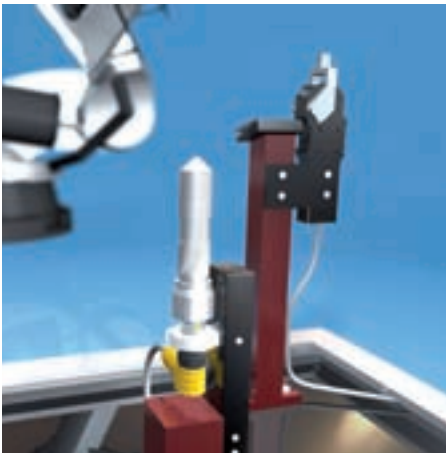
Eine übergestülpte Zentrierhülse aus Edelstahl fixiert die Schweißmutter und gibt zusätzlichen mechanischen Schutz
