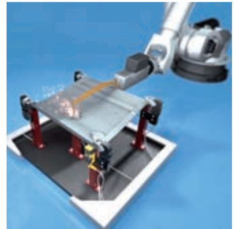
Nach Freigabe durch die SPS punktet der Schweißroboter die Mutter und Hülse an das Blech
